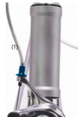
Der Druckpunkt der Bremsen kann mittels der Stellschraubchen (2R) oder (2L) am Bremshebel eingestellt werden. Alternativ kann auch das Stellschraubchen (1) am Bremskörper verwendet werden. Bei voll angezogenem Bremshebel sollte der Hebel nicht weiter als die Hälfte des Hebelwegs angezogen sein.
