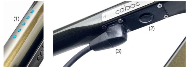
Bei Tiefensteiger-Rahmen befindet sich die LED-Anzeige auf der Oberseite des Unterrohrs (4). Die LED-Anzeige ist gleichzeitig die Power Taste. Drücken auf die LED-Anzeige betätigt den Taster. Die Ladebuchse (5) befindet sich auf der Unterseite des Oberrohres, dass sich direkt über dem Tretlager befindet.
